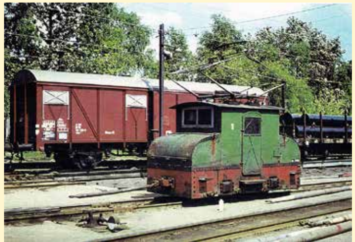
Der urige E-Lok-Veteran E 1 im Kleinbahnhof der Wandsbeker Industriebahn; auch wenn die Lok alleine fuhr, blieb die Kupplungsstange meist an der Lok.
