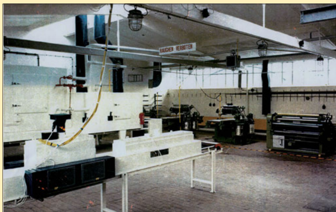
Das neue Technikum ca. 1969 mit Walzspachtelmaschine, Walzauftragsmaschine, Gießmaschine, UV-Kanal, Infrarotkanal mit lang-/mittel-/kurzwelliger Strahlung und zusätzlich konventioneller Umluft-Technik.
